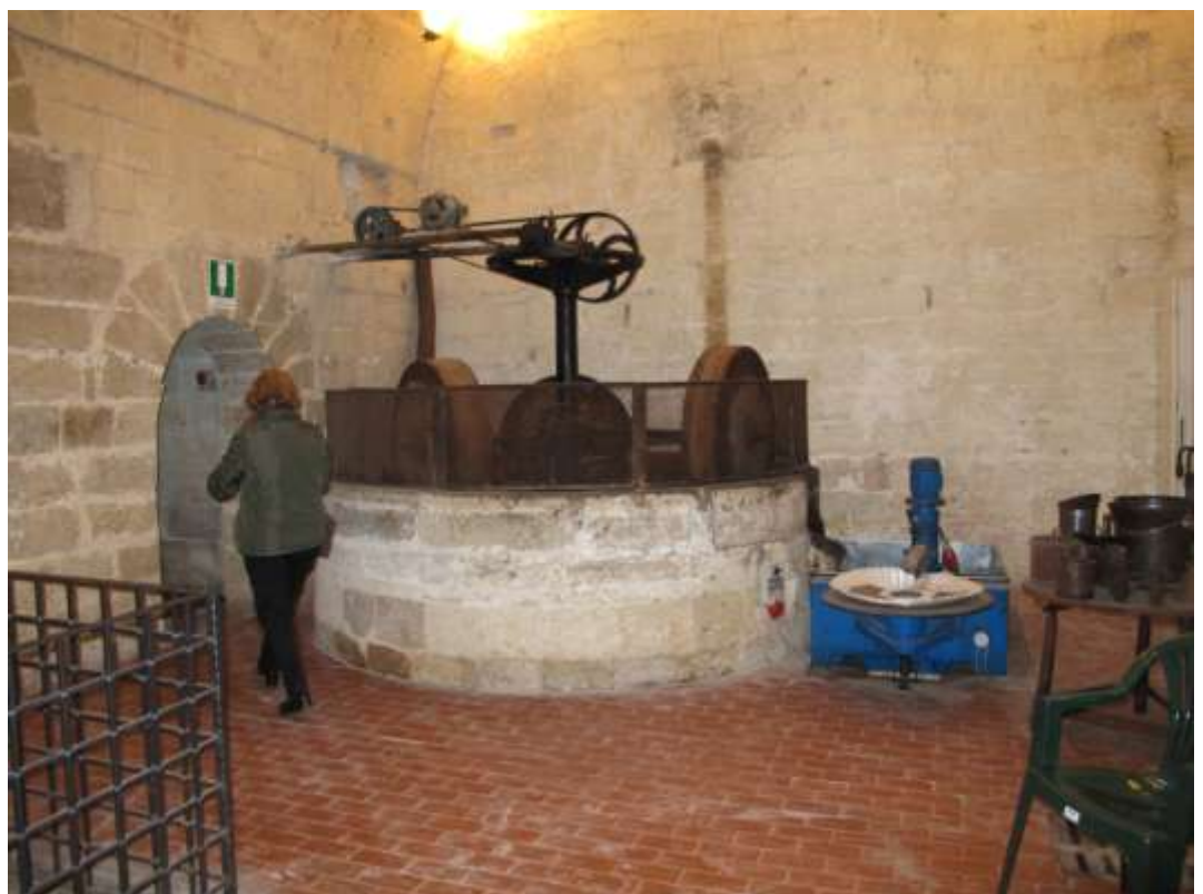
In alto , torchi alla genovese risalenti al 1600 e, in basso , macina di pietra ancora oggi usata per la produzione di olio "a freddo"
